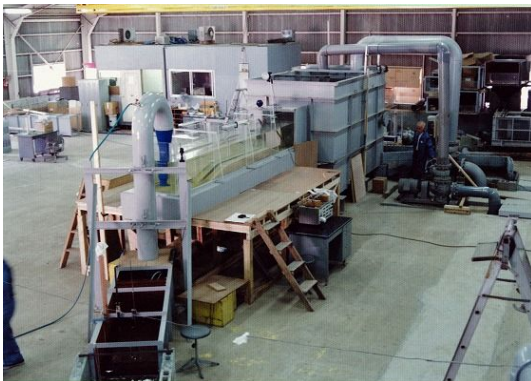
図-1 ポンプ取水槽の水理模型実験例
