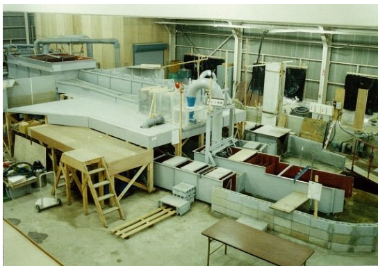
図-3 ポンプ取水槽の水理模型実験例
